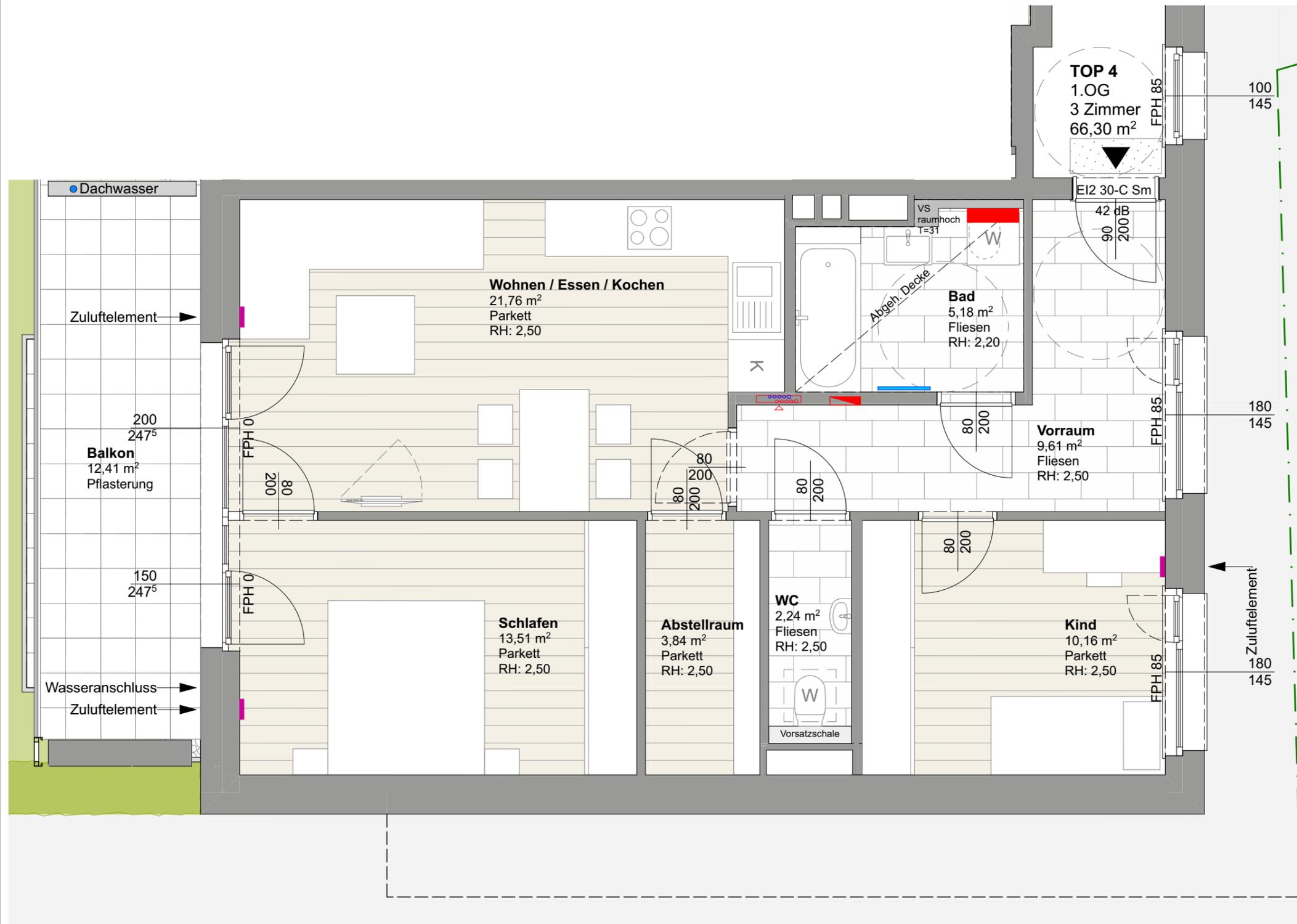
Einrichtungsgegenstände in Bereichen vor Zuluftelementen dürfen eine maximale Höhe von 2,10m nicht überschreiten. Einrichtungsgegenstände sind von der Außenwänden um mind. 5cm abzurücken.
